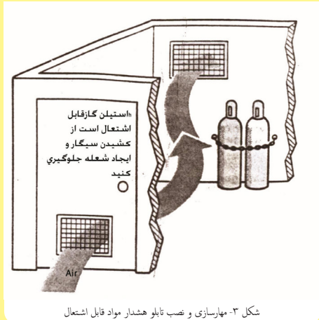
شکل ۳- مهارسازی و نصب تابلو هشدار مواد قابل اشتعال
