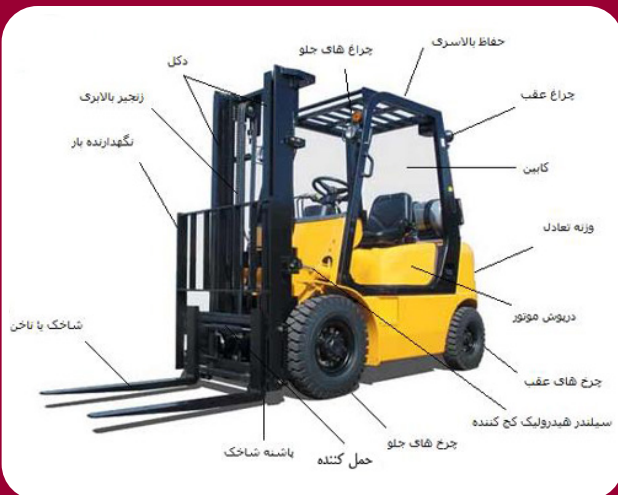
شکل شماره ۲- برخی اجزاء لیفتراک
